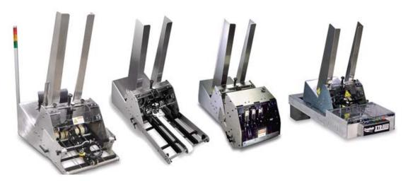
Conçu pour un fonctionnement intensif dans un environnement industriel, l'ossature du **ST 1250 Pro** est en inox et les composants ont été soigneusement sélectionnés. Un vaste choix d'options hardware et software est proposé pour s'adapter au mieux aux intégrations spécifiques et aux contraintes d'applications.
